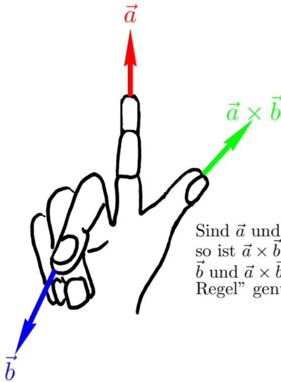
Sind  $\vec{a}$  und  $\vec{b}$  linear unabhängig, so ist  $\vec{a} \times \vec{b}$  so orientiert, dass  $\vec{a}$ ,  $\vec{b}$  und  $\vec{a} \times \vec{b}$  der "Rechte Hand Regel" genügen.
