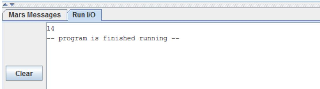
Nun bleibt nur noch das Beenden des Programms, was wie in den anderen Simulationen dieser Reihe *Simulationen mit dem MARS Simulator* auch, über den Wert 10: *terminate execution* für den *syscall* passiert:
