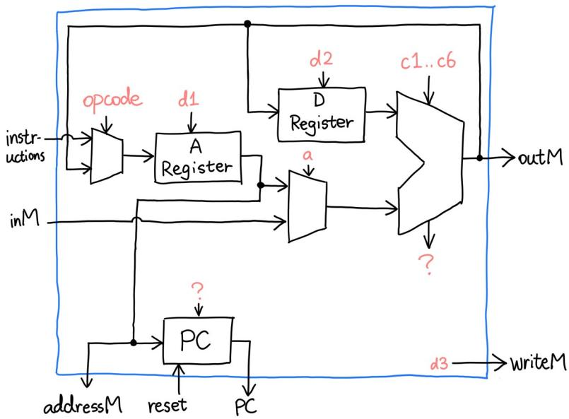
Das ist einfach, aber falsch. Schauen wir uns den mit dem A-Register **load**beschrifteten Pin genauer an d1. @1Was passiert, wenn wir versuchen, Adresse 1 mithilfe einer A-Anweisung hineinzuladen ? Lass es uns zusammenbauen:
